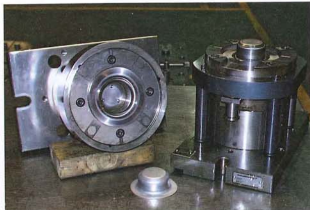
Stampo per imbutitura di acciaio inox costruito in acciaio Uddeholm Vancron 40
