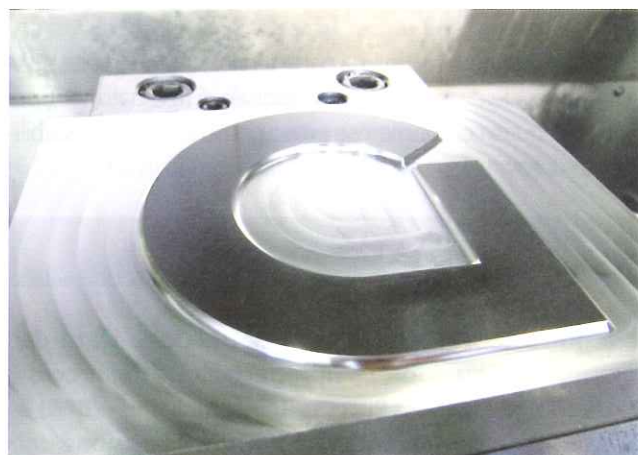
Sgrossatura logo iGuzzini su acciaio Uddeholm Sleipner a 60 HRC eseguita con fresa a inserto APHP di Hitachi Tool.
