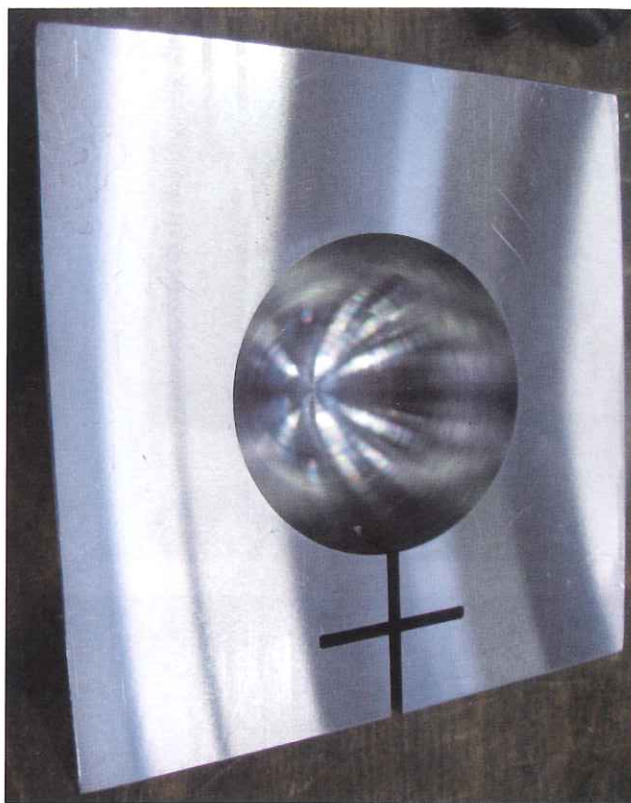
Finitura e nervatura su un acciaio Uddeholm Nimax a 40 HRC eseguite con frese serie Panacea ed Epoch Turbo Mill di Hitachi Tool.
