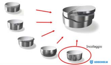
Tipici meccanismi di avaria nelle lavorazioni a freddo
